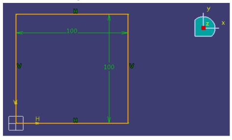
Кнопкой «Выход из модуля» покиньте режим построения эскиза. Квадрат отобразится в изометрии.
