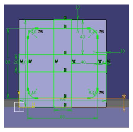
Как видно из изображения, все элементы определены. Выбрав инструмент быстрой обрезки последовательно щёлкните на внутренних линиях прямоугольников, что бы образовать один контур:
