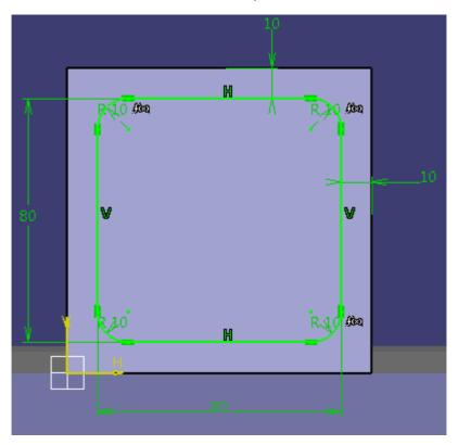
Теперь следует скруглить углы полученного квадрата. Выбрав инструмент, с не совсем корректным названием «Угол», очертите вокруг угловых точек прямоугольную рамку. Установите радиус равный 10 мм и нажмите Enter. Если всё сделано правильно, рабочая область должна иметь следующий вид:
