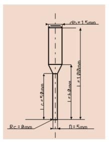
Параметры инструмента можно менять. Рассмотрим это на примере диаметра фрезы. Двойным щелчком выберете в дереве Pocketing.1 и переключитесь на вкладку настройки инструмента.
