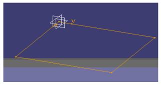
Сейчас следует превратить плоский эскиз в объёмную модель. В зависимости от задачи и требуемой формы это можно сделать различными способами с различными параметрами. Воспользуемся способом «Выдавливания».
