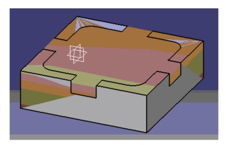
Нажав «Insert STL File» выберите файл заготовки, сохранённый ранее. Заготовка совместится с готовой деталью.
