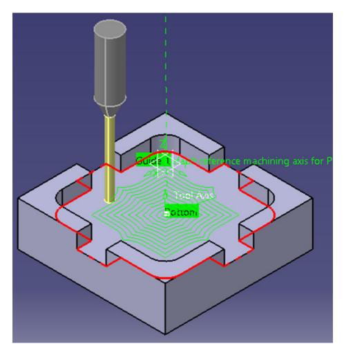
Установите размер фаски равным нулю, а диаметр фрезы равным пяти миллиметрам. Нажмите Tool path reply . Посмотрите новый ролик движения инструмента. Сохраните файл.
